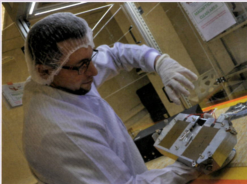
Komplex termikus műhold-alkatrész fűtőlapokkal, termoelemekkel az ADMATIS tisztaszobájában
